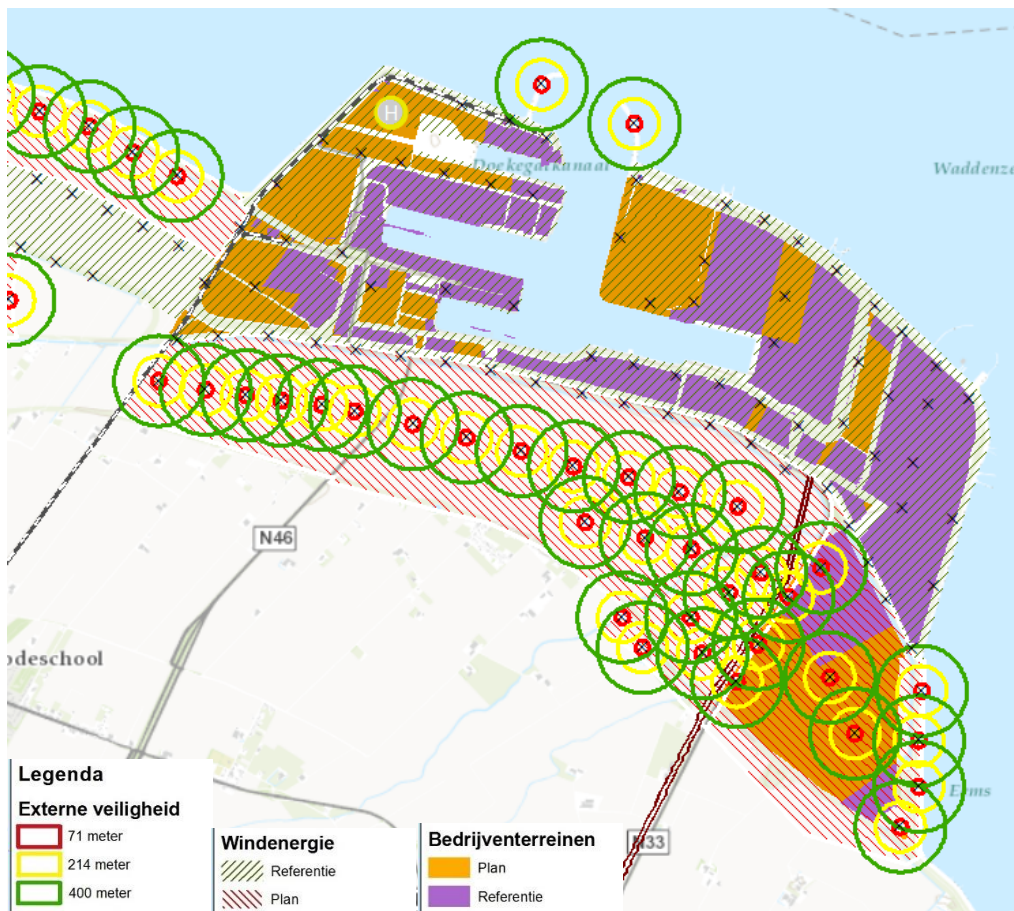
Figuur 4-3 Voorkeursalternatief, signaleringsafstanden Windpark Oostpolder
