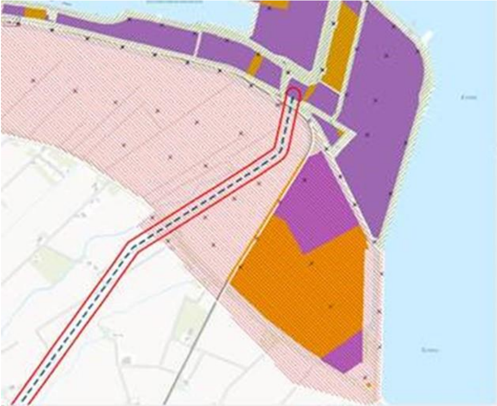
Figuur 3-14 Belemmeringenstrook hoogspanning
