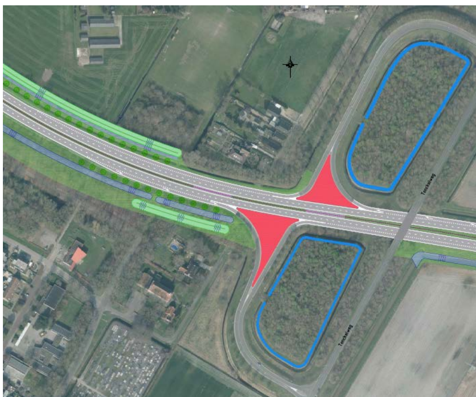
Figuur 13. Principe verdubbeling N366- Veendam-Pekela met aansluiting Ommelandervijk/Zuidwending
