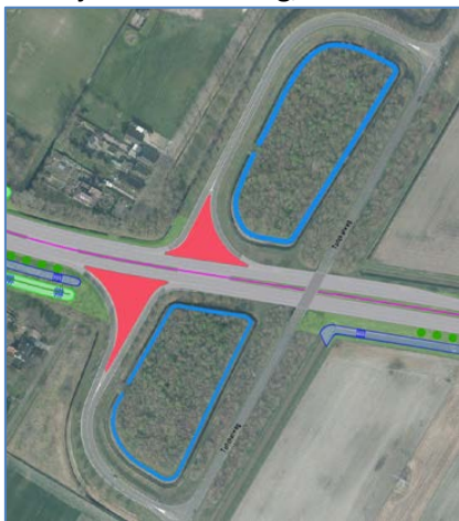
Figuur 33. Ruimte voor waterberging Tonckelweg
